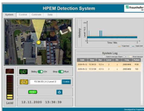
Webinterface zur Steuerung und Anzeige
